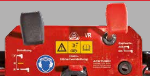
Overzichtelijk bedieningspaneel, hoogteregeling stuur en schakelschema
