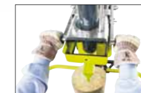
Veiligheidsschakeling voor twee handen in serie
