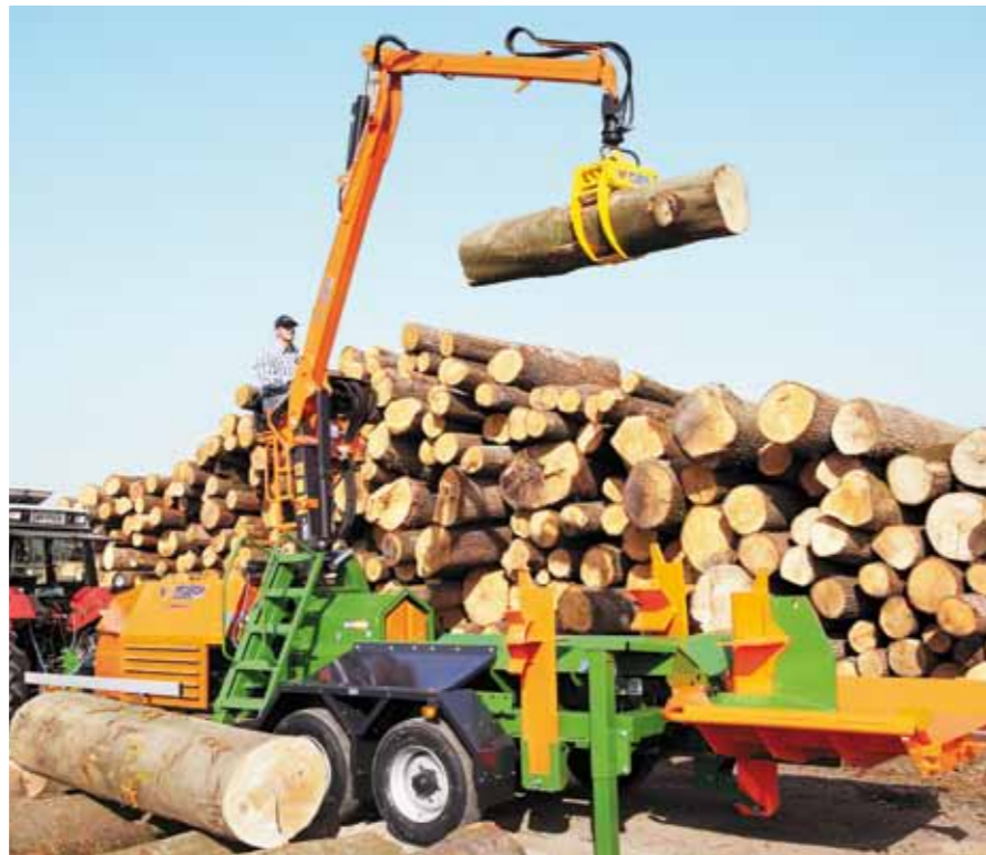
SplitMaster 55 Crane. De laadkraan heft stammen tot een gewicht van 1.200 kg in de splijtgroef.
