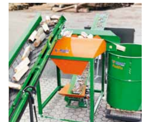
Een optionele transportband onder de zeef leidt de afvalstukken naar een willekeurige container. De propere houtblokken vallen hier in een PackFix-vultrommel.
