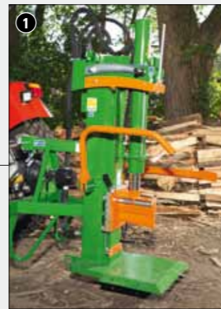
1 Neetlaatbare cilinder voor eenvoudig transport en plaatsbesparende opslag.
