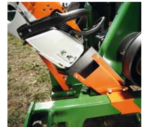
Optionele motorzaaghouder (F0003357) voor veilig transport en praktische mogelijkheid om de motorzaag weg te leggen
