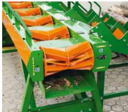
Robuuste waltransporteur voor de continue stapeling met de SpaltFix.
