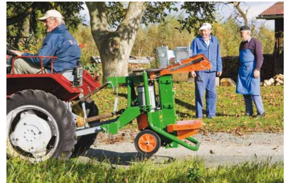
Gemakkelijk te vervoeren: SpaltAxt 10 Speciaal met driepuntsophanging (F0002577) als speciale uitrusting.
