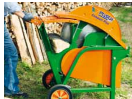
Wipzaag met optie (S): de geïntegreerde beschermingsbekleding voorkomt dat men tijdens het snijden per abuis naar het zaagblad grijpt.
