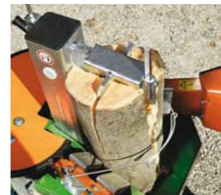
Driepuntsophanging voor SpaltAxt 8 (F0002576) maakt probleemloos en economisch vier houtblokken in één ruk mogelijk.
