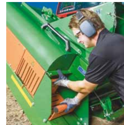
Gereedschapsloze verstelling van de langsaanslag.
