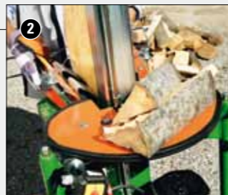
De houtlegtafel in serie dient voor de tussentijdse plaatsing van de houtblokken tijdens het kloven.
