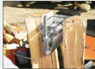
Het verschuifbare kloofmes met rollen (in serie bij SpaltAxt 8 Speciaal en SpaltAxt 10 Speciaal) spaart kracht bij het kloven. Het hout springt snel op en de rollen aan het kloofmes verhinderen dat het gekloofd hout bij de retourloop blijft haperen.
