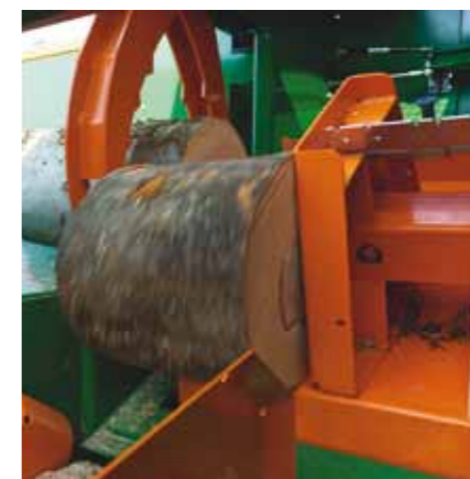
Optimale houtoverdracht vanaf de zaagzone door hydraulische houtwip.
