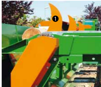
De optionele uitdunningsster 1 geeft de houtstammen afzonderlijk aan de overlangse transporteur.
