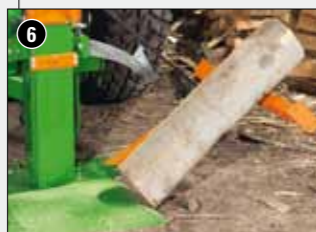
6 De mechanische stamhefinrichting in serie brengt het splijtgoed moeiteloos in startpositie. Hydraulische stamhefinrichting voor meer bedieningscomfort als speciale uitrusting.
