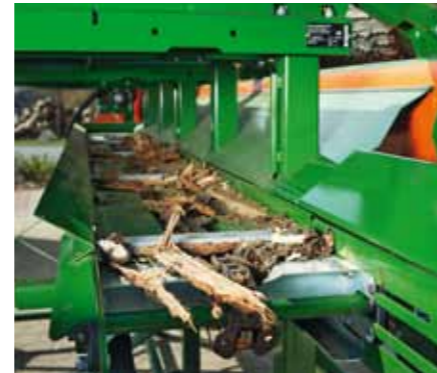
Bijkomende uitrusting: de optionele reinigingsband transporteert houtafval onder de dwarse transporteur naar een willekeurige container.
