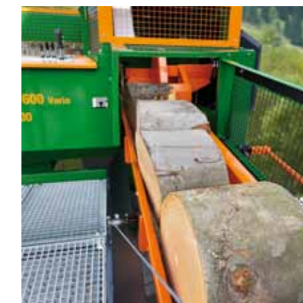
Het stamhout wordt door een wip over de 2 m lange bufferband aan de AutoSplit overgedragen.
