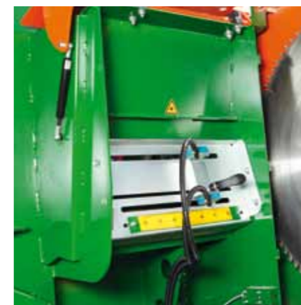
De houtlengtemeting kan traploos ingesteld worden via de optische sensor.
