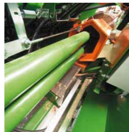
Krachtig en snel. Het dubbelcilindersysteem zorgt voor een dubbel zo snelle terugloop en zodoende hogere prestaties per uur.
