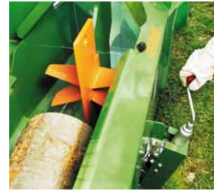
Het kloofmes is gemakkelijk handmatig in de hoogte verstelbaar.
