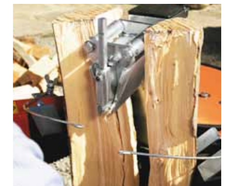
Het verschuifbare kliefmes met rollen bespaart kracht tijdens het splijten. Het hout springt snel op en de rollen aan het kliefmes verhinderen dat het gespleten hout bij de retourloop blijft haperen.
