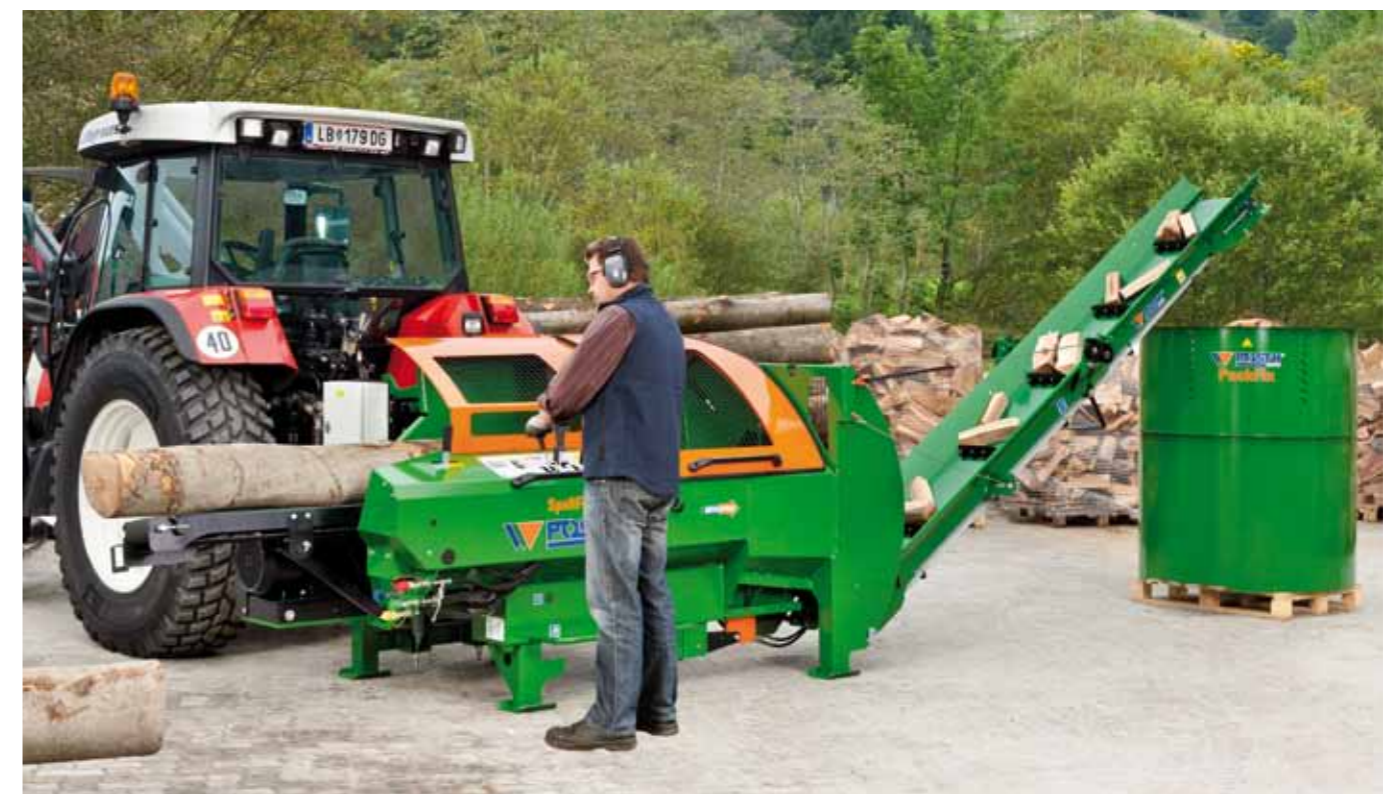
SpaltFix S-360 ZE22D met geknikte transportband voor de houtafvoer en verpakingsoplossing PackFix voor de optimale verpakking van brandhout.
