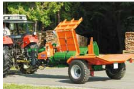
De SplitMaster 30 met voortslepend tractorrijdstel voor mobiel gebruik.
