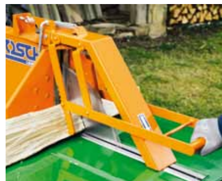
Vlot lopende tafelgeleiding met kogellagers voor optimaal bedieningscomfort.
