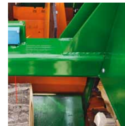
SplitControl voor de automatische meting van de houthoeveelheid en de verstelling van het kliefmes. Gelijkmatische houtblokken zijn het resultaat hiervan.
