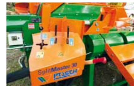
Tweehandsebediening. Joystick voor hefinrichting en mesverstelling.
