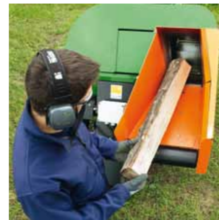
Comfortabele houtaanvoer door de geringe hoogte en de beide rollen in de houtlade.
