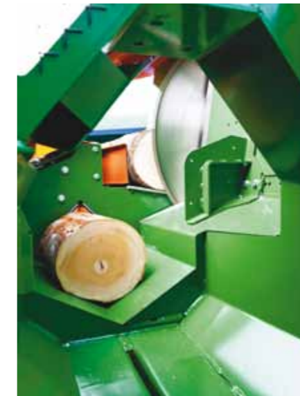
OnlyCut-systeem: De SpaltFix S-360 kan ook als hoogperformante zaag zonder kliefmes gebezigd worden.
