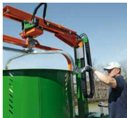
De vultrommel kan eenvoudig met een handgreep van de frameconstructie ontkoppeld worden.
