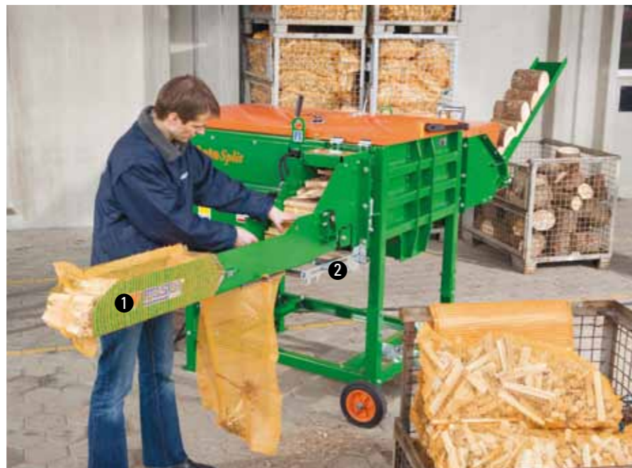
1 AutoSplit 250 met verpakkingssleuf voor gelaagde verpakking.
