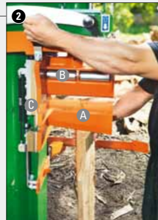
2 Fixomatic-systeem in serie: door de activering van de ingebouwde houtneerhouder in het gedeelde kliefmes wordt het houtblok comfortabel gepositioneerd. De ingebouwde rollen in het kliefmes voorkomen dat het zachte hout tijdens de terugloop vastklemt.
