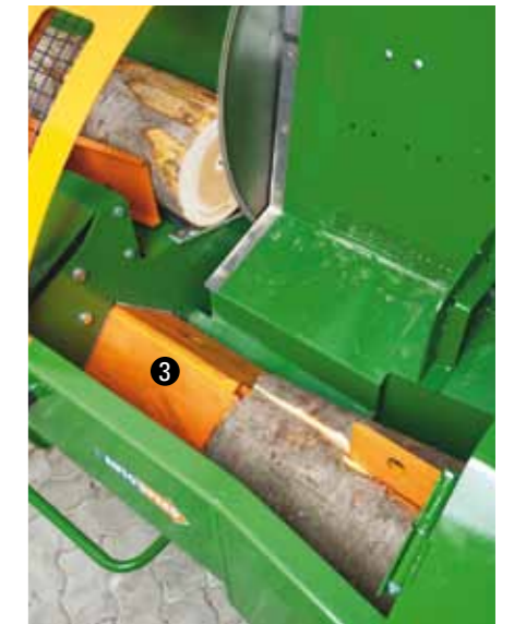
Het kernstuk van de SpaltFix S-360 1 WIDIA-zaagblad Ø 900 mm met hydraulische aanvoer 2 Automatisch verluchtende houtaanslag voorkomt het klemgeraken van het hout 3 De stempel drukt het hout met een kliefkraft van 12 t tegen het aan weerszijden snijdende kliefmes
