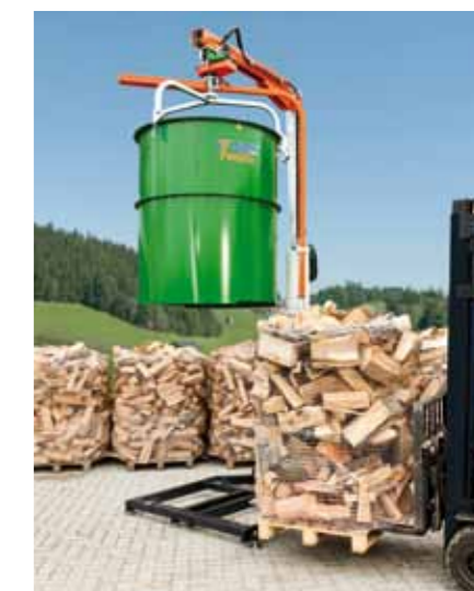
Nadat de vultrommel volledig naar boven is weggetrokken, kan het afgewerkte 'houtpak' afgevoerd worden.
