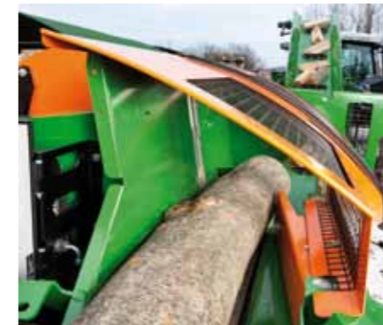
De hydraulische houtneerhouder verhindert dat het houtstuk klem geraakt
