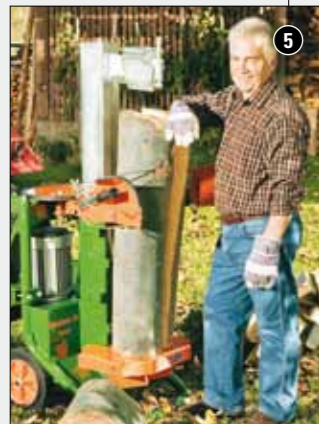
In de speciale uitvoering is ook het occasionele kloven (klooflengte 54 cm) van meterhout mogelijk.
