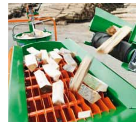
De draaiende walsen halen de ongewenste spaanders en schorsstukken uit het brandhout.
