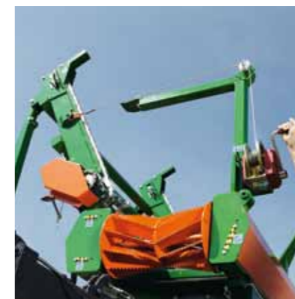
De dwarse transporteur kan met een trekkabel of hydraulisch comfortabel in werkpositie gebracht worden.
