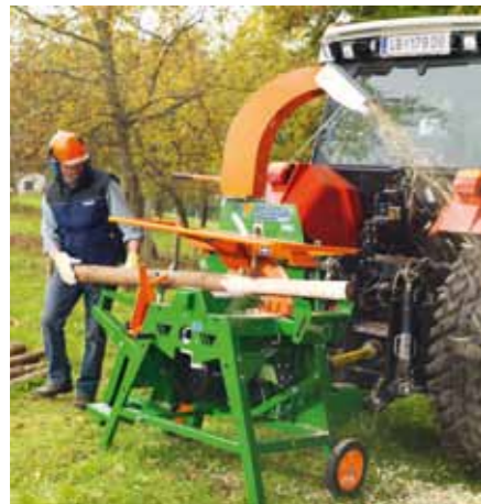
De SchälProfi maakt eenvoudig schillen met aansluitend scherpen van boomstammen mogelijk.
