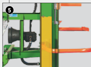
5 Het optimaal gedimensioneerde hydraulische systeem met terugloopfilter en ingebouwde veiligheidsolietaank met dubbele bodem zorgt voor de hoogste bedrijfsveiligheid en een lange levensduur.
