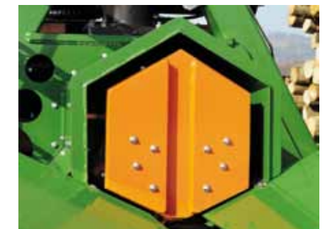
De stempel drukt het splijthout met meer dan 40 / 55 t door het kloofmes.
