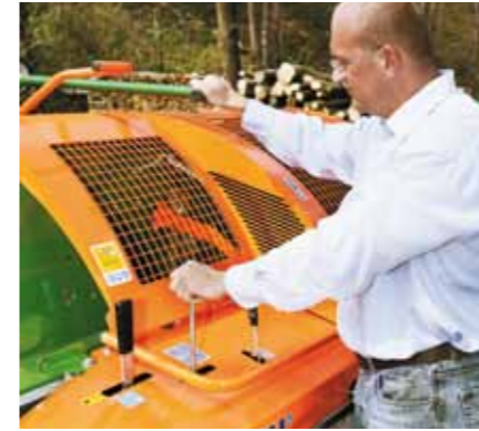
De bediening van de houtneerhouder en het zaagblad geschiedt met de ergonomische handinvoer.
