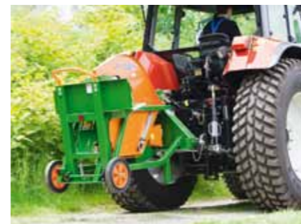
de wipzaag laat zich via driepuntsophanging comfortabel en snel naar haar plaats van gebruik transporteren.
