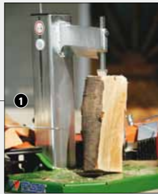
Met de houtvasthoudspits kan ook dun of schuins afgesneden hout gemakkelijk gefixeerd en moeiteloos gekliefd worden.
