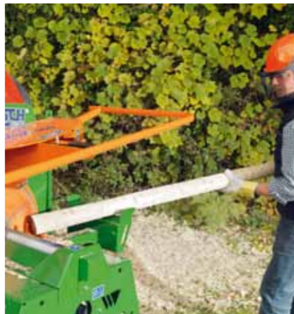
De SchälProfi maakt eenvoudig schillen met aansluitend scherpen van boomstammen mogelijk.
