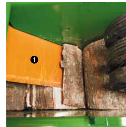
in de kern van de machine wordt rond of vierkant hout alle drie seconden meermaals door het V-vormige kloofmes 1 gekloofd en tot kachelklaar aanmaakhout verwerkt.
