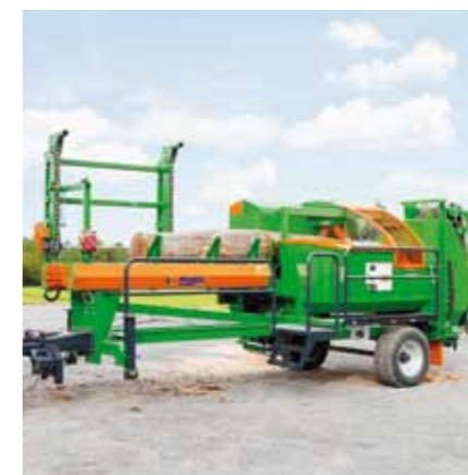
De SpaltFix K-540 kan optioneel met het tractorrijdgestel comfortabel getransporteerd worden.
