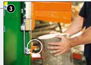
3 Gepatenteerde houtvasthoudspits fixeert schuin afgesneden houtstammen.
