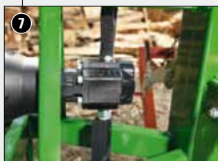
7 De grote, zachtjes lopende industriële gietijzerpomp zorgt voor een veilige bediening op den duur, met een laag toerental van de PTO.
