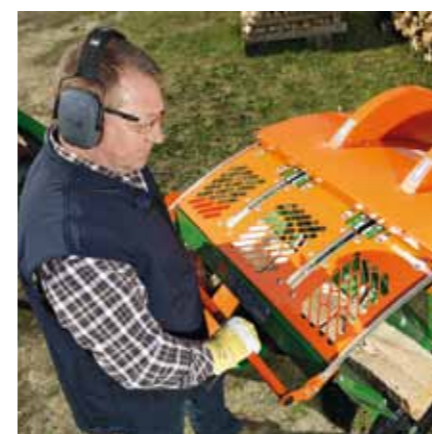
De geïntegreerde beschermingsbekleding voorkomt dat men tijdens het snijden per abuis naar het zaagblad grijpt.
