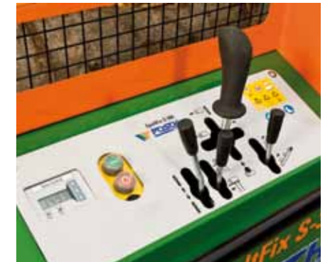
Joystickbesturing met één hand voor comfortabele bediening en optionele Saw-Control voor automatische bewaking van het zaagbladtoerental.
