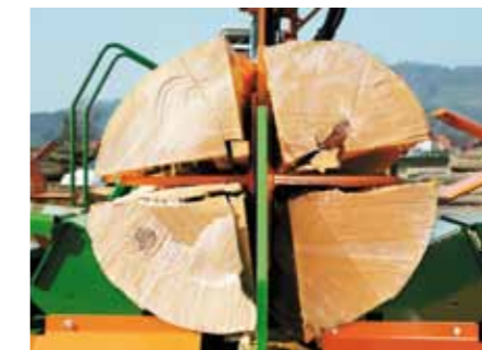
Het hydraulisch verstelbare kloofmes voor krachtig kloven van het splijthout.
