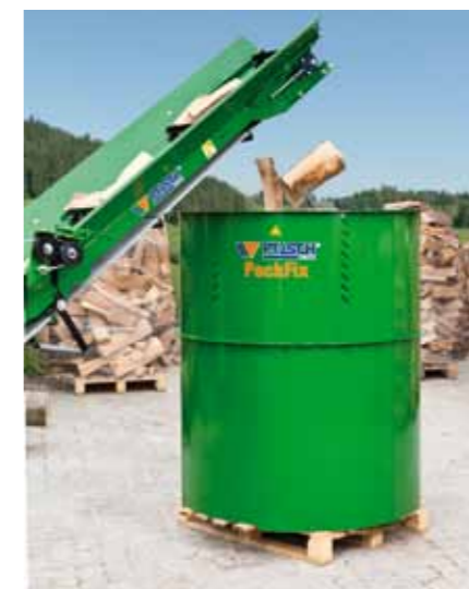
De PackFix-trommel wordt middels een transportband gevuld.
