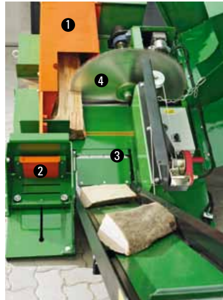
Het kernstuk van de SmartCut 700: 1 Houtlade 2 Langsaanslag 3 SensoStart-systeem 4 WIDIA-zaagblad Ø 700 mm
