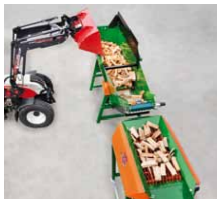
De LogFill met extra frame (F0003498) kan met een frontlader beladen worden.
