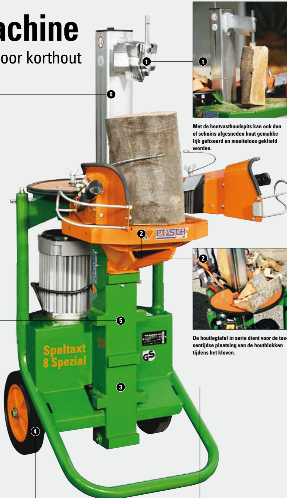
Het verschuifbare kloofmes met rollen (in serie bij SpaltAxt 8 Speciaal en SpaltAxt 10 Speciaal) spaart kracht bij het kloven. Het hout springt snel op en de rollen aan het kloofmes verhinderen dat het gekloofd hout bij de retourloop blijft haperen.
