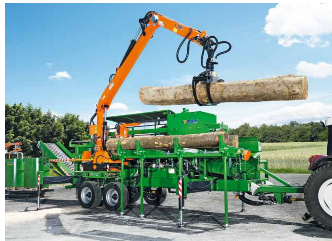
Mobiele SpaltFix K-550 met houtlaadkraan en kniktransportband voor de houtafvoer.
