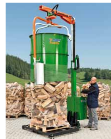
...tezelfdertijd wordt de vultrommel (die niet draait) naar boven getrokken.
